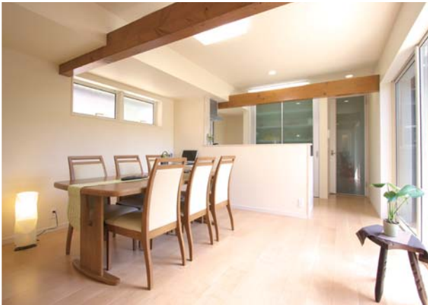
改築後のS邸。古い躯体を残し、むき出しの梁で補強。インテリアとして効果的に利用した。
